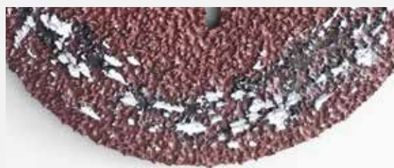
Фибровый диск, забитый алюминиевой стружкой
