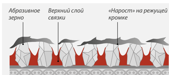
Традиционный абразив: Стружка прилипает к вершинам зерен, и абразив засаливается.
