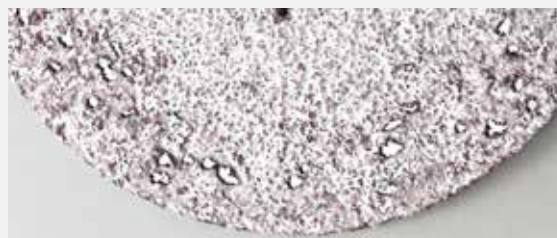
VSM STEARATE Plus : стружки прилипает намного меньше
