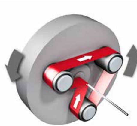
Снятие окалины с катанки при помощи планетарного метода шлифования
